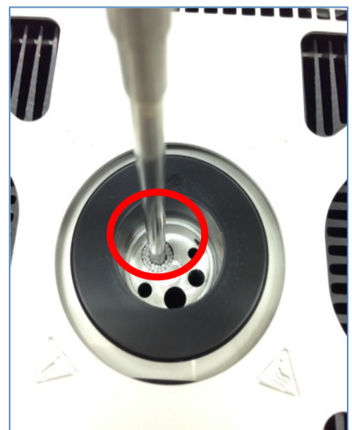
③センサー位置を微調整して アルミナボールを均一に満たす。
