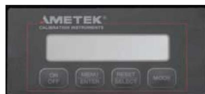
DTI-1000は、最新のDC測定技術とマイクロプロセッサ技術を利用して設計されました。ケーブル・ソケット及びセンサーからのEMFを消去することで、抵抗値の真の測定を行い、高精度の測定が可能となりました。
