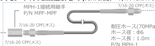
オプション クイック接続校正用チューブ(70MPa対応) P/N : YBKPH-03
