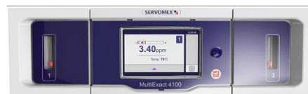
全世界で多数の実績がある4100型分析計の後継機種です。精度0.01%の磁気ダンベル式酸素センサーを複数搭載可能で、酸素センサーの他に微量CO<sub>2</sub>、水分トランスミッターも選択できるマルチガス分析計です。
