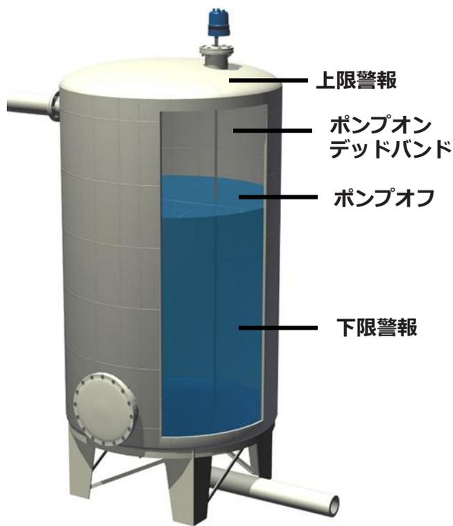
ドレキセルブルック、マルチポイントIIは1本のセンサーで最大4点の動作ポイントを制御可能です
